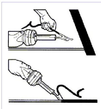
Сразу после сварки следует срезать выступающую над поверхностью покрытия часть шнура с помощью резака с лезвием в форме полумесяца. При необходимости, второй раз проделать ту же самую операцию можно после окончательного охлаждения шнура с использованием указанного инструмента. (см. рис.)
