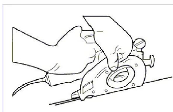
Швы рулонных покрытий Polyflor завариваются с помощью ручного сварочного аппарата с одним быстродействующим нагревающим соплом при температуре порядка 200 - 250°C. (см. рис.)
